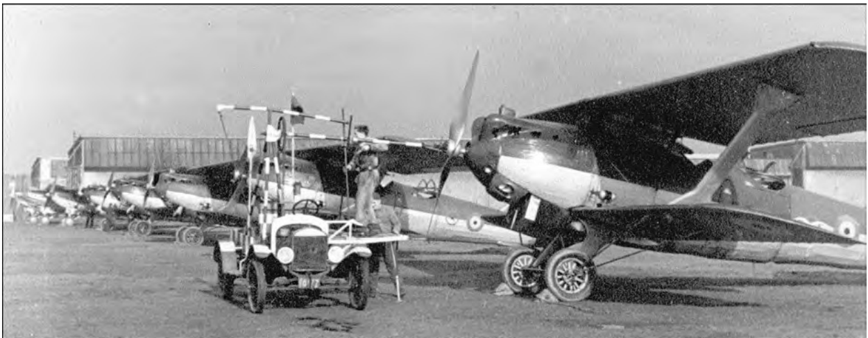
De werktuigkundigen maken de Breguet XIX klaar die toegewezen zijn aan de luchtvaartschool in het begin van 1939. Op de voorgrond, de "Hucks starter" die toeliet de motor te starten zonder de schroef met de hand te moeten aanzwengelen.
